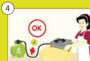
4 Pastikan selang tidak tertindih, tertekuk, atau retak dan bocor
