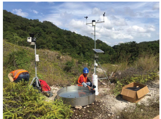
Staff PT. STM melakukan pengecekan alat Stasiun Curah Hujan secara berkala, untuk memastikan alat tersebut berfungsi dan terhubung dengan jaringan internet agar data dapat tetap tercatat dengan baik. Untuk keakuratan data, staff PT. STM juga mengunduh data curah hujan yang sudah terekam secara otomatis dari stasiun tersebut untuk memvalidasi data yang sudah didapatkan secara online.
